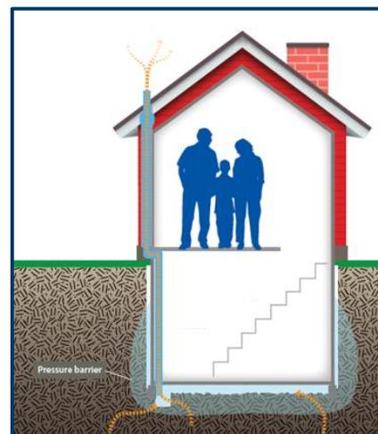
Los sistemas de mitigación de vapor funcionan al crear una barrera de presión que impide la intrusión de vapor.
